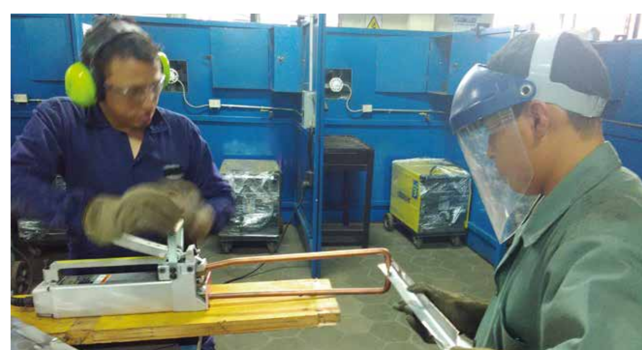
Figura 4: afinado de proceso de soldadura
