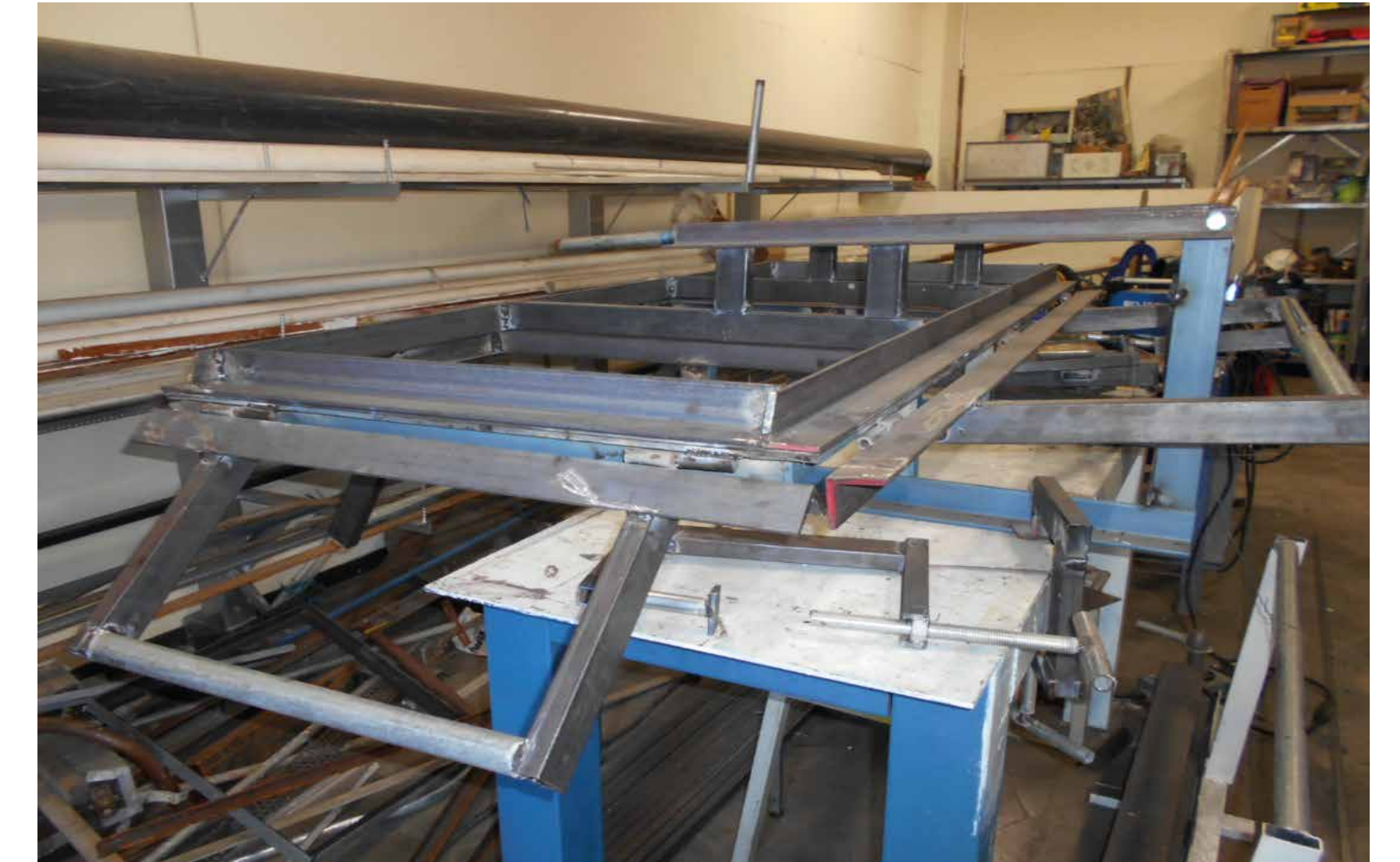
Figura 5: Máquina dobladora de lámina para la manufactura de cajas térmicas del colector. Forma parte del desarrollo del proceso de fabricación en serie.
