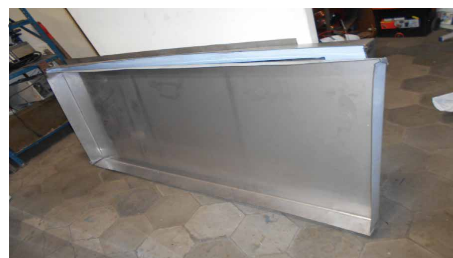
Figura 3: Caja térmica recién salida de la máquina dobladora de lámina y lista para el proceso de soldadura y colocación del contramarcos del panel frontal de vidrio.
