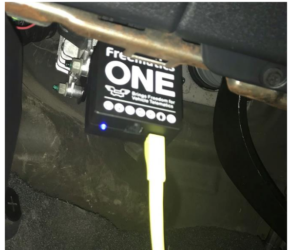
Fig. 7. Prototipo de hardware conectado al vehículo.
