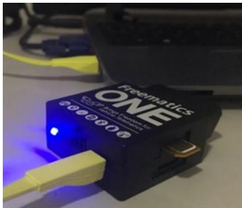
Fig. 5. Carga del algoritmo de extracción en el prototipo de hardware (puerto USB).
