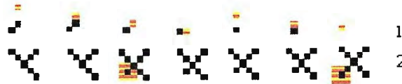
Figura 3.2.2.1.7 Al pasar el muestreo de der. a izq. se toman los datos que fueron ignorados en el anterior muestreo, completándose el caracter en la ventana de muestreo.
