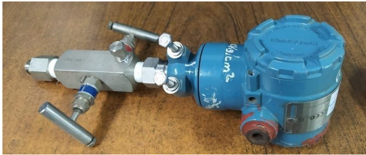
Ilustración 21. Transmisor de presión de agua de alimentación
