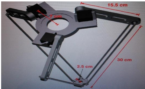
Fig. 8 Diseño final con medidas del robot delta.
