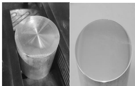
Figura 6. Pieza de aluminio 6061-T6 en E.E. (izquierda), pieza de aluminio lijada hasta lija 3000 y posteriormente con óxido de aluminio hasta 1 micrómetro (diámetro de la partícula - derecha).
