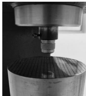
Figura 9. Pieza de aluminio pulida y marcada, previa a realizar las indentaciones.
