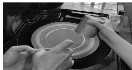
Figura 5. Proceso de pulido con polvo abrasivo de óxido de aluminio.
