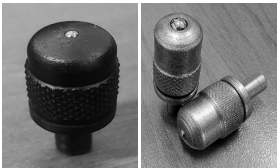
Figura 1. Indentadores bola de acero endurecido con diferentes diámetros. a) indentador de bola (2.50 mm) previo a la remoción de capa superficial de óxido. b) indentadores de bola (5.00 mm y 1/8 in) después de la remoción de óxido con químicos, cepillo de cerdas latonas y plásticas, recubrimiento de una capa externa de pintura para protección contra la humedad.
