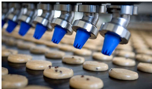
Ilustración 27. Ejemplo de la distribución para la inyección de jalea previo al ingreso en un horno tipo túnel
