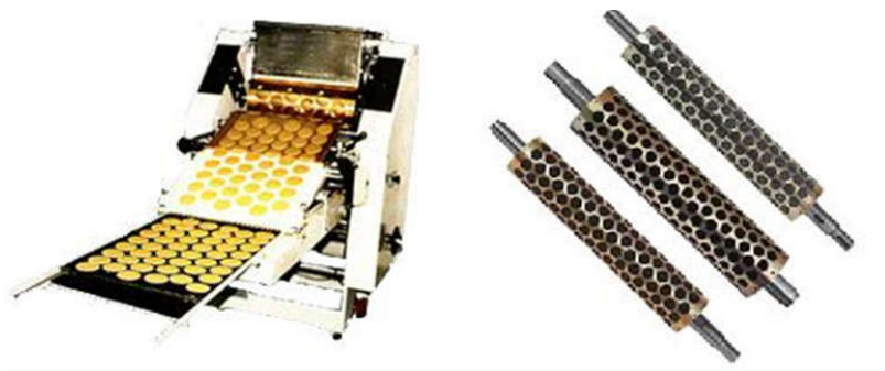
Ilustración 26. Máquina de preformado para galleta, preforma troquelada de masa cruda, de troquelado variable.
