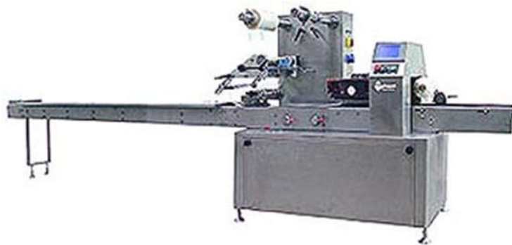
Ilustración 32. Empaquetador de galletas múltiple con sello de lote y fecha de vencimiento.
