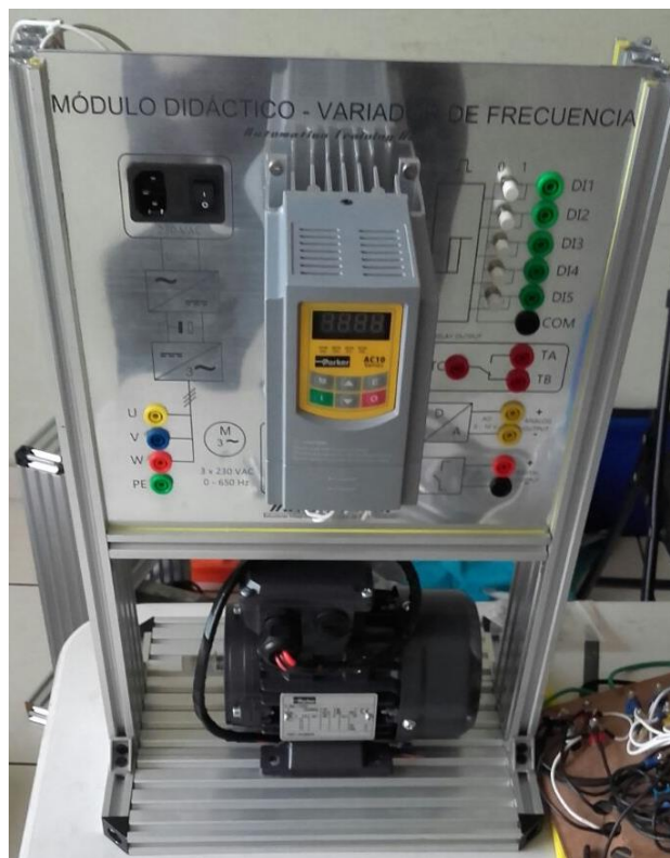
Ilustración 1. Módulo didáctico variador de frecuencia
