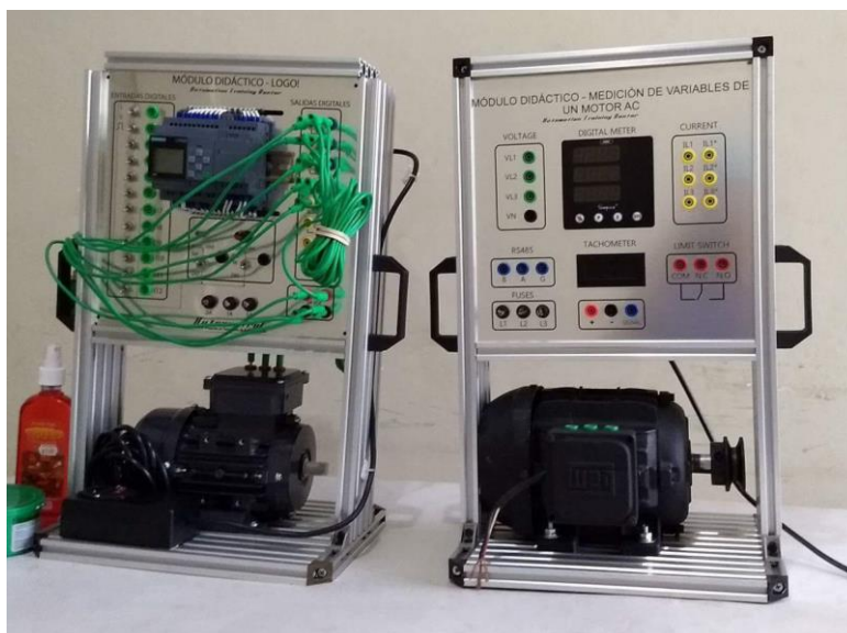
Ilustración 6. Módulo didáctico - PLC y variador de frecuencia
