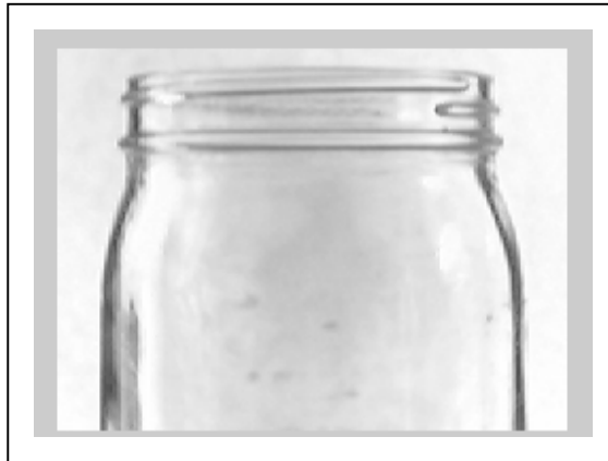
Figura 1.9 imagen captada con la técnica de iluminación posterior difusa
