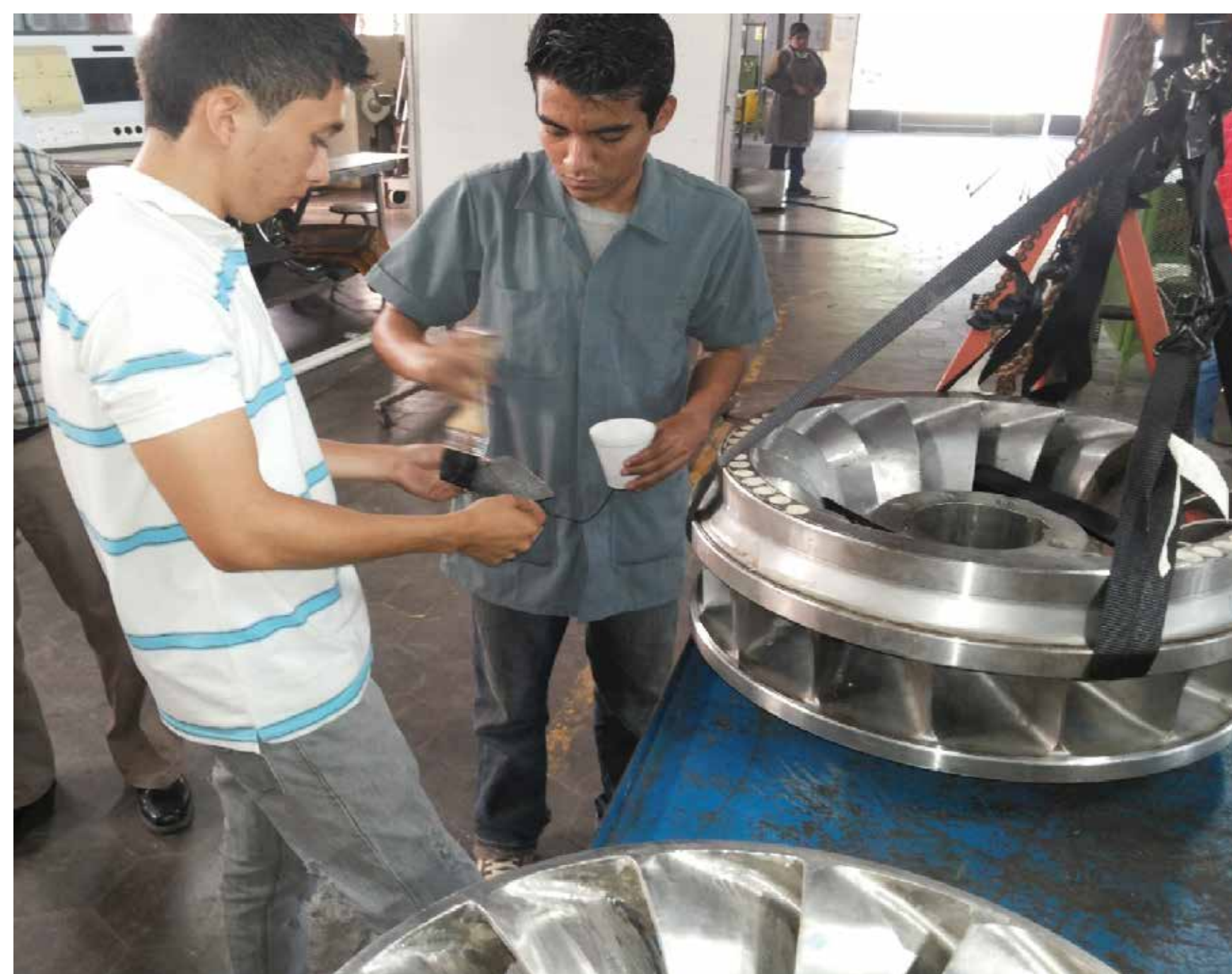
Figura 1: Detalles de Turbina Francis, a la cual se le rediseñará el rodete.
