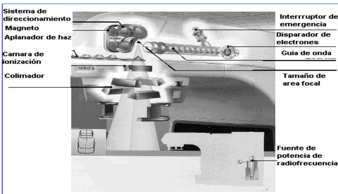
FIGURA 2.2. Esquema de un acelerador lineal de electrones 6 .
