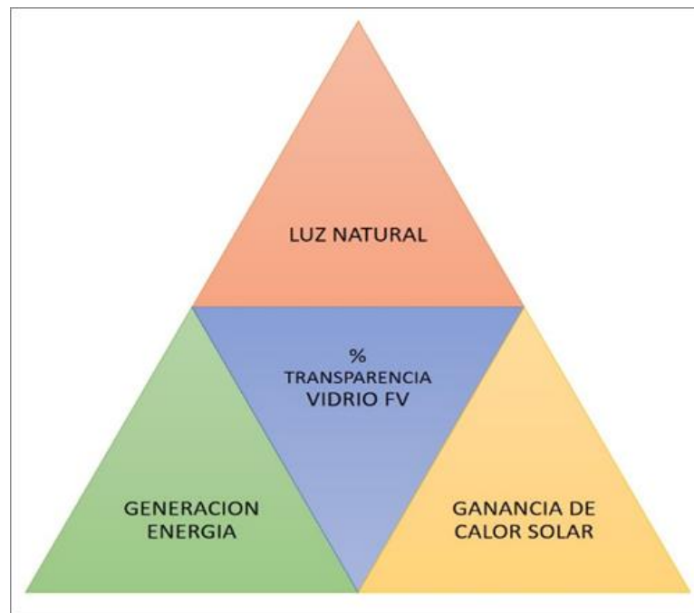
Figura 12: Matriz de Variables Afectadas por el Agrado de Transparencia de los Vidrios Fotovoltaicos. (Fuente: construible.es, 2024)
