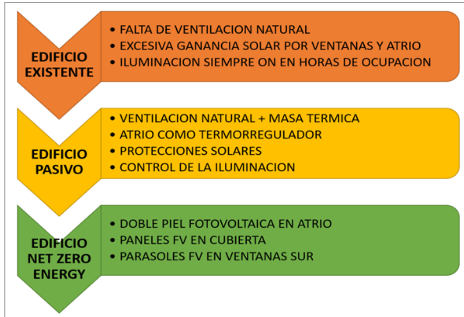
Figura 11: Diagnóstico y Medidas a Implementar para la Mejora del Balance Energético.(Fuente: construible.es, 2024)
