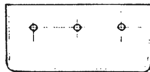
FIJACIÓN MEDIA UNA SOLA FILA DE TORNILLOS
